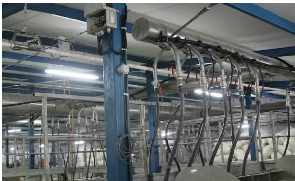
ИООО «Ясельда». Цех кормоподачи с силосами кормозагрузки и оборудованном автоматизированной шнековой и пневматической кормоподачей. Основной цех: Дозаторы и датчики пневматической линии раздачи корма. Бесконтактное с человеком кормление рыбы.
